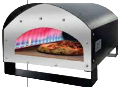
FORNO A GAS PER PIZZA 'PERSEO' con alimentazione a gas GPL, portatile a cottura diretta. Camera di cottura in acciaio inox AISI430, base in pietra, temperatura regolabile fino a 500° C, accensione piezo, termocoppia di sicurezza. Progettato per essere utilizzato in casa, sul terrazzo, in giardino. 45x60xh32 cm Cod. 500421
